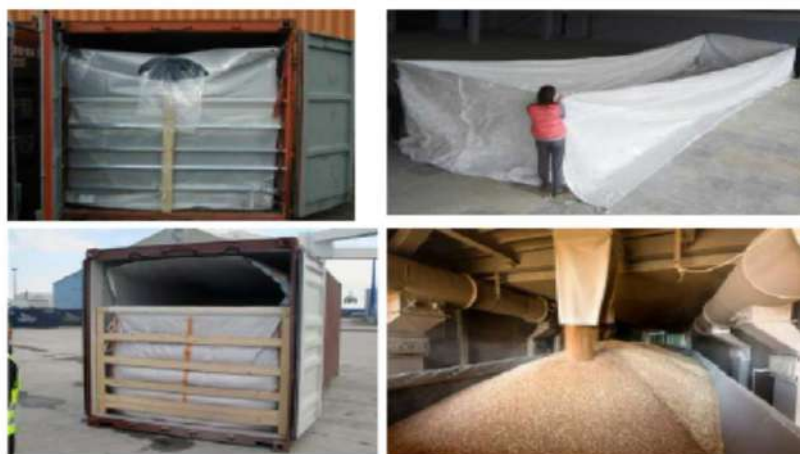
Сурет 4. Контейнерлерді және жартылай вагондарды полипропиленматадан жасалған төсеммен тасымалдау үшін пайдалану
