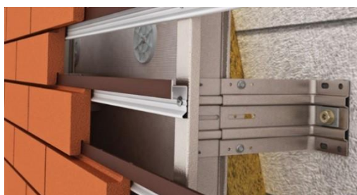
Рисунок 5. Утепление вентилируемым фасадом
